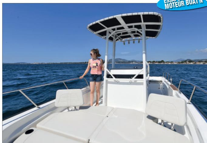
Ci-dessus : à l'avant, deux petits dossiers amovibles offrent deux places supplémentaires dans le sens de la marche. Ci-dessous : le dossier du siège du pilote bascule vers l'avant pour obtenir une double assise orientée vers l'arrière. En bas à gauche : l'avant reçoit un bain de soleil.
