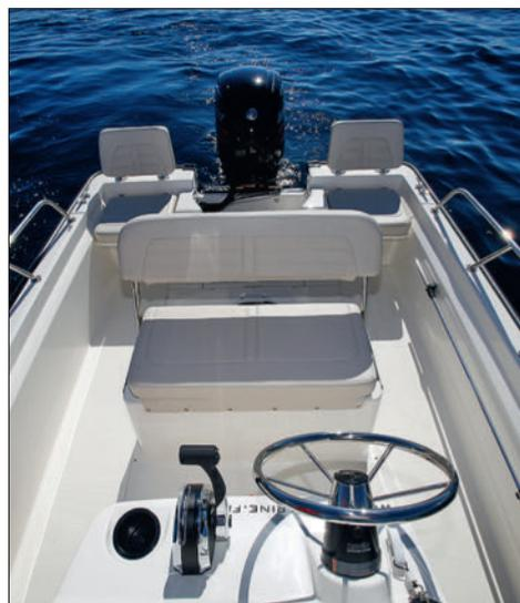
Ci-dessus : la barre du poste de pilotage est décalée sur bâbord, laissant plus d'espace pour le passage sur tribord.
