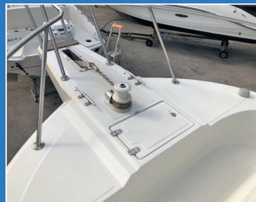
La delphinrière est intégrée au moule du pont (et non rapportée), ce qui offre davantage de rigidité à l'ensemble.
