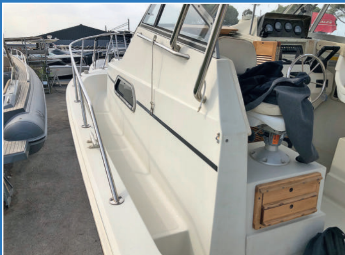
Les balcons en inox qui entourent les passavants et la partie avant sont en bon état. Une petite passivation permettra de retrouver le brillant initial.
