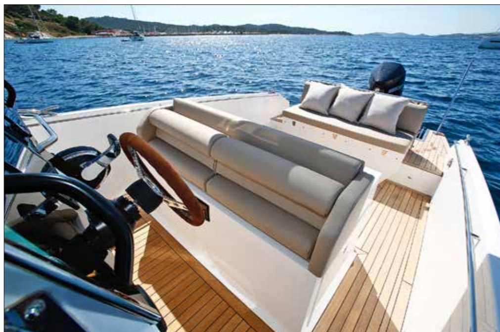
Le chantier a fait le choix pertinent d'un leaning-post, avec des assises rabattables pour piloter debout en appui fessier.
