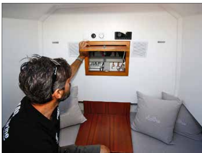
Les accès aux câbles de l'instrumentation se font depuis l'intérieur de la cabine, derrière une trappe en bois verni.
