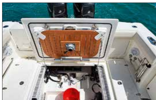
Le capot de la cale arrière, très profonde, est monté sur vérins. Il intègre également un rangement pour la table de cockpit.
