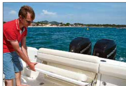
Le système de banc escamotable dans les pavois est repris à bord de ce 330 Outrage.
