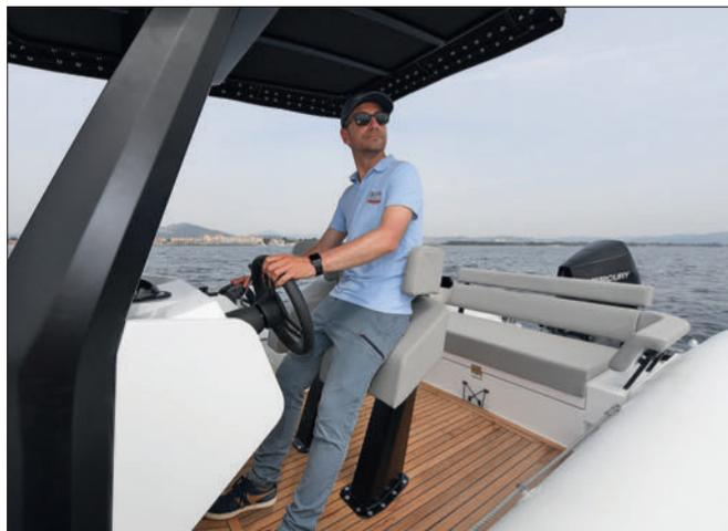
L'assise du pilote et du copilote est un mélange de leaning-post et de siège jockey. Le maintien est parfait, même à haute vitesse.
