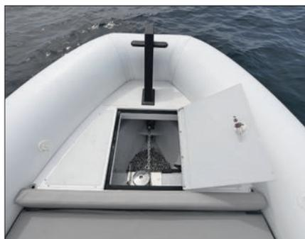
La baïlle à mouillage est située dans la pointe, sous un capot qui la dissimule.
