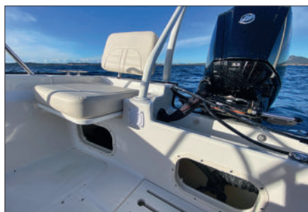
Des petits coffres étanches sont placés dans le tableau arrière et sous les sièges du cockpit.
