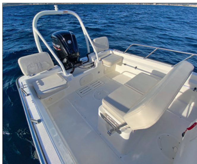
Le dossier de la banquette pilote bascule vers l'avant pour offrir une double assise orientée vers les deux petits sièges installés de part et d'autre du moteur.
