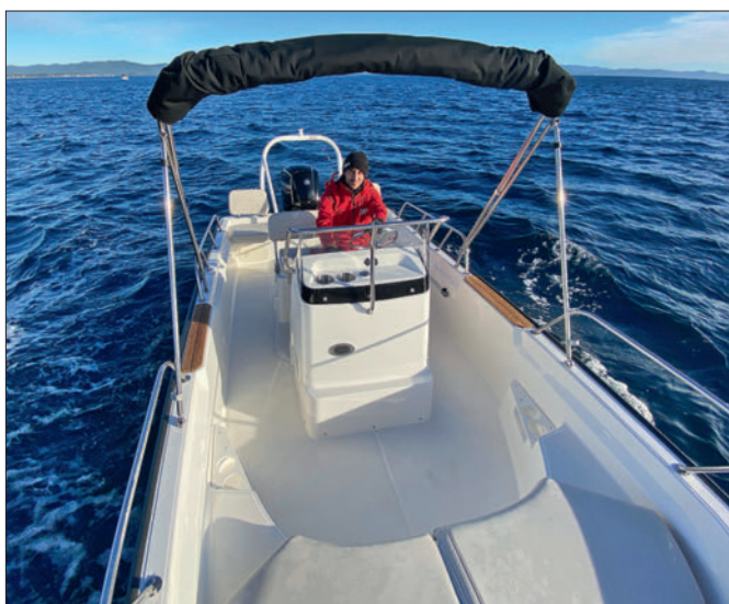
Sur chaque bord, au niveau de la console, les plats-bords sont recouverts de teck pour l'embarquement depuis le quai, mais la présence du bimini (optionnel) gêne.
