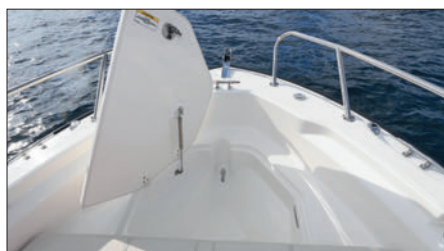
Belles finitions et solidité se retrouvent même dans la baille dont le capot est assisté par un solide vérin.
