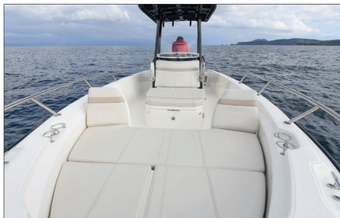
Les deux petites assises latérales qui débordent du bain de soleil avant se transforment en dossierets une fois relevées. L'avant du bateau peut être protégé du soleil par un taud fixé au T-top et maintenu par des petits mâts.
