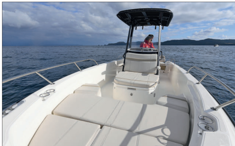
Les deux petites assises latérales qui débordent du bain de soleil avant se transforment en dossierets une fois relevées. L'avant du bateau peut être protégé du soleil par un taud fixé au T-top et maintenu par des petits mâts.
