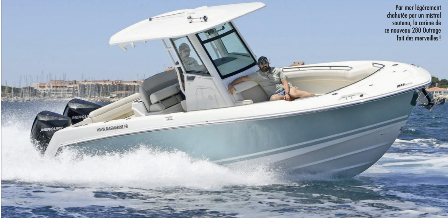
et tout est pensé à bord pour ce loisir : porte-cannes, francs-bords rembourrés pour se caler lors des actions de pêche, viviers, coffres à plat pont... Une grande soute centrale accueille le parc de batteries, les pompes de cale et les filtres à carburant.
