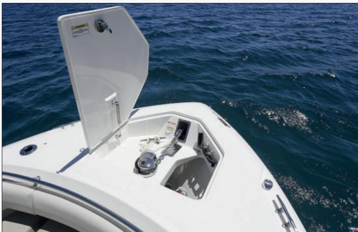
La baïlle à mouillage et le guindeau sont dissimulés sous un capot monté sur vérin. L'ancre est à poste en permanence et traverse le haut de l'étrave.
