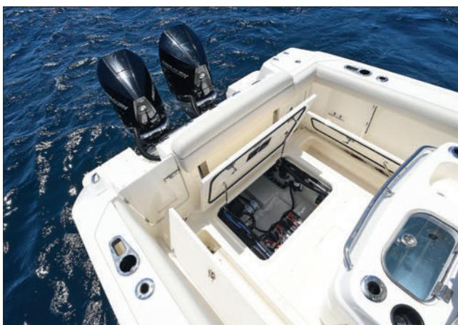
Le cockpit est occupé par de nombreux capots à plat pont, qui dissimulent deux viviers et une grande soute centrale où prennent place les batteries.
