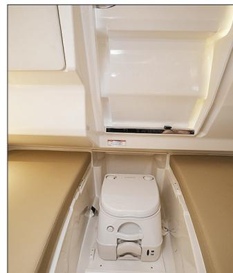
Les WC chimiques en standard se rangent sous le plancher du cockpit.
