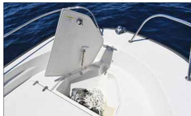
À l'image de ce capot de baille à mouillage, la plupart des pièces mobiles sont contre-moulées. L'accastillage est bien dimensionné et de bonne facture.
