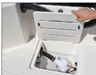
Une pompe de cale électrique assure l'évacuation de l'eau hors du cockpit.
