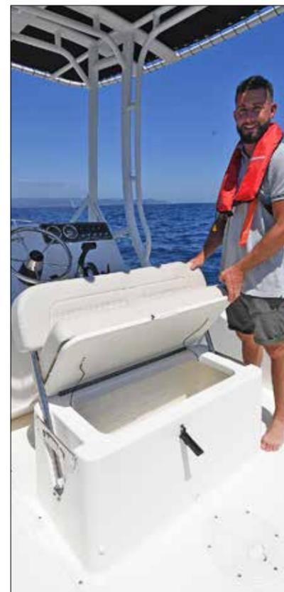
Il est nécessaire de basculer le dossier pour ouvrir le capot de la banquette.
