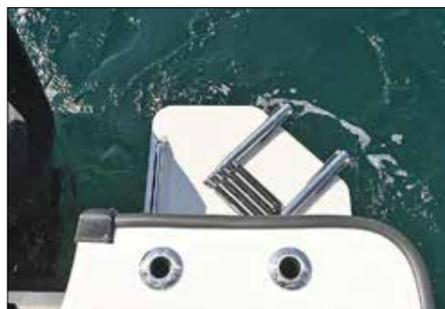
L'unique plage de bain et son échelle télescopique se fixent à bâbord. Une main courante facilite les remontées.
